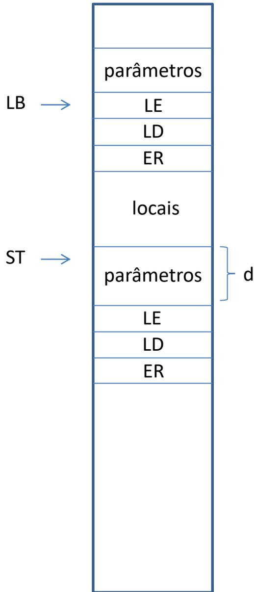
1. Desempilha o valor de retorno (RV, "n" posições do topo da pilha) e armazena num registrador temporário  $T_1$ ;
