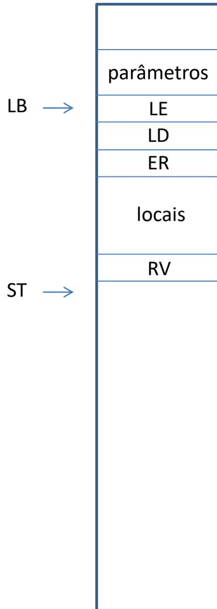
1. Desempilha o valor de retorno (RV, “n” posições do topo da pilha) e armazena num registrador temporário  $T_1$ ;
